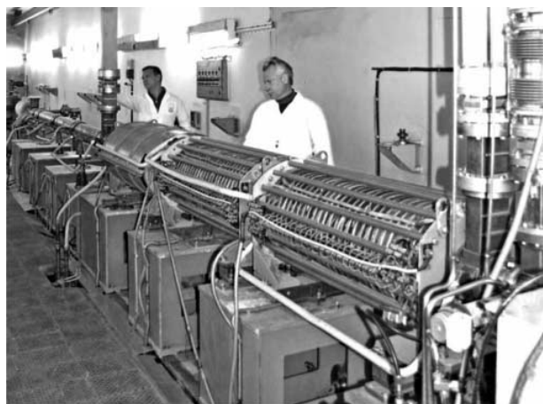
Рис. 7. Ускоритель электронов ЛУ-50. Граничная энергия электронов 50 МэВ, диапазон энергий фотонейтронов от 0,1 до 15 МэВ (создан совместно с Московским радиотехническим институтом). (Фотография В.А. Разуваева.)
