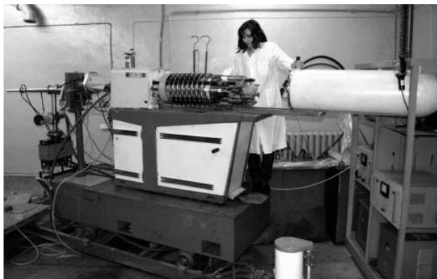
Рис. 9. Образцовый источник термоядерных нейтронов: длительность импульса 30 нс, частота повторений (1-5) \times 10^5 Гц, погрешность определения флюенса 14-МэВ-ных нейтронов \pm 2,5\% . Статический генератор нейтронов разработан в Научно-исследовательском институте электрофизической аппаратуры им. Д.В. Ефремова (НИИЭФА), импульсный режим реализован во ВНИИЭФ. (Фотография А.Е. Малеева.)
