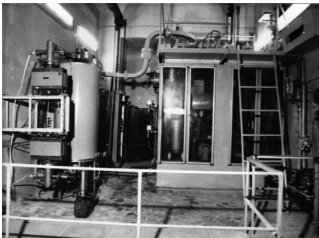
Рис. 18. Линейный резонансный ускоритель ЛУ-10-20, предназначенный для моделирования дозового воздействия гамма-излучения. (Фотография В.А. Разуваева.)
