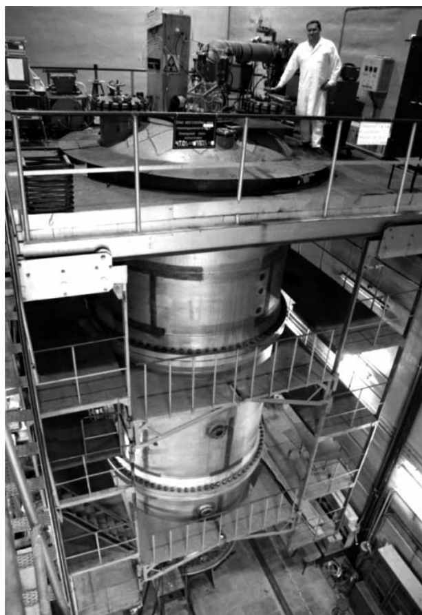
Рис. 8. Электростатический перезарядный генератор (тандем) ЭГП-10, рабочий диапазон энергий ускоренных протонов от 1,0 до 12 МэВ; типы ускоренных частиц: ионы протия, дейтерия, трития, кислорода, углерода; источник отрицательных ионов — дуоплазмотрон. (Фотография А.Е. Малеева.)
