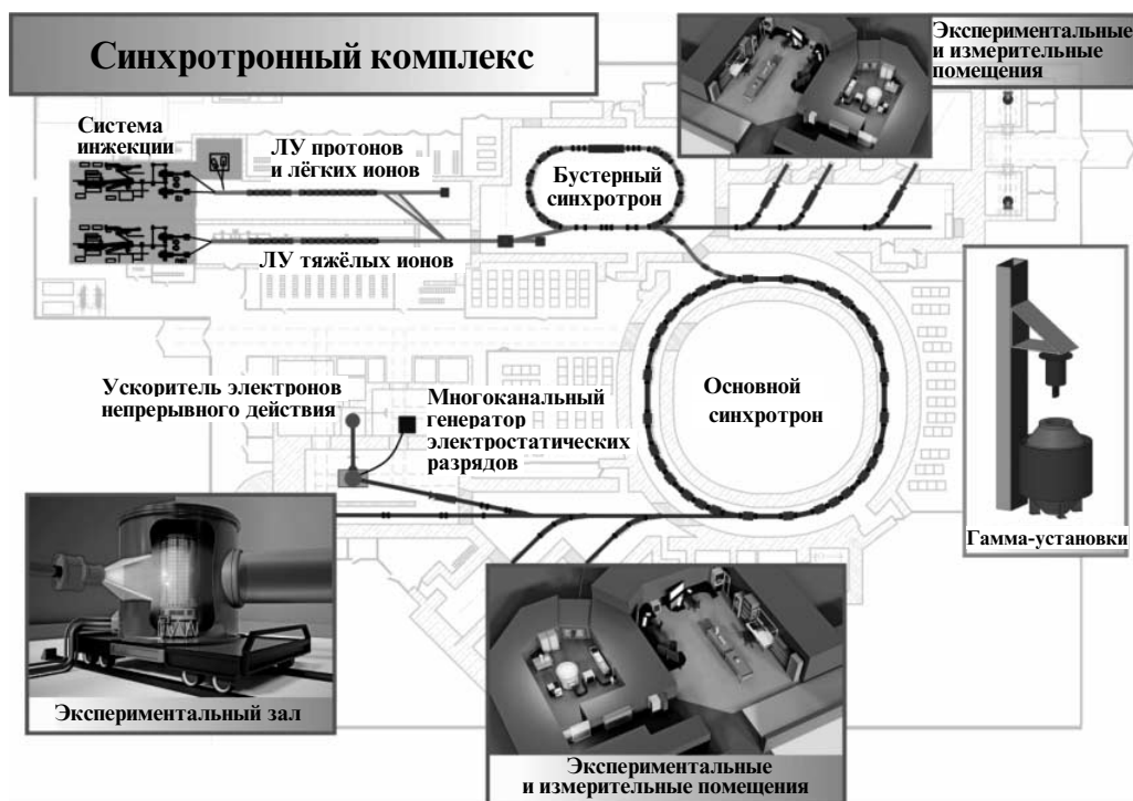
Рис. 21. Состав оборудования и помещения МЦКИ.
