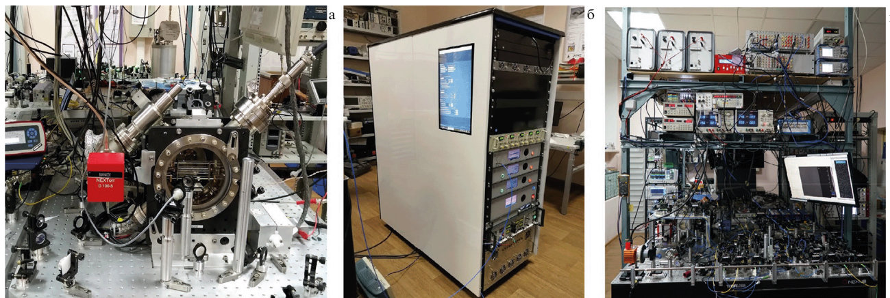
Рис. 4. История развития исследований ионов в ловушках в ФИАН. (а) Первая ионная ловушка для ионов магния и иттербия. (б) Транспортируемые оптические часы на одиночном ионе ^{171}\text{Yb}^+ . (в) Первый в России 4-кубитный квантовый компьютер на холодных ионах ^{171}\text{Yb}^+ .
