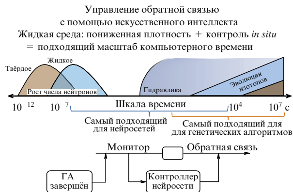
Рис. 6. (В цвете онлайн.) Возможность управления с обратной связью при использовании жидкого расплава соли. Для обратной связи важно, что иерархия времён в трансмутаторе с жидким расплавом соли не содержит несравнимых масштабов, как в твердотельном случае (ядерный тип взаимодействий против гидродинамических взаимодействий).
