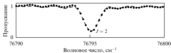
Рис. 4. Спектр пропускания синхротронного излучения атомом кислорода O(2p^4\ ^3P_J \rightarrow 3s^3\ ^3S_1^o) в плазме атмосферного давления, фрагмент для J = 2 .
