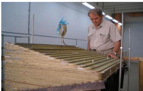
**Рис. 8.** Пробная секция тороидального СПИН-30, состоящая из 36 галет, намотанных непрерывным отрезком провода сечением  $2 \times 10$  мм и длиной 800 м.
