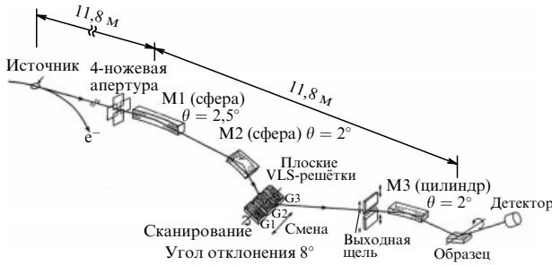
**Рис. 8.** Рефлектометр на основе монохроматора со сменными плоскими VLS-решётками ( $G_1 - G_3$ ), использующего синхротронное излучение:  $M_1, M_2$  — сферические зеркала скользящего падения,  $M_3$  — цилиндрическое зеркало скользящего падения,  $\Omega = 8^\circ$ . (Адаптировано из [32].)
