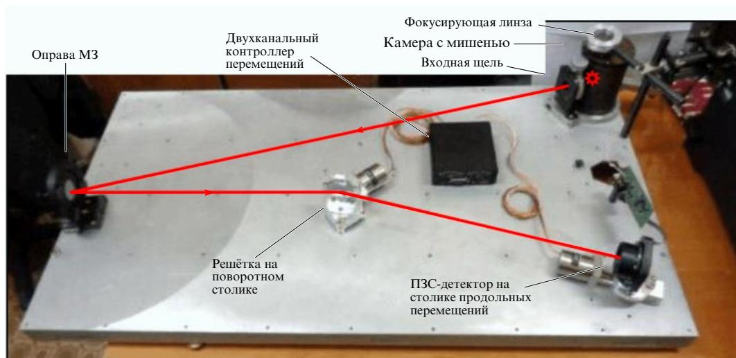
**Рис. 22.** Элементы спектрографа, размещённые на дюралевой плате размером  $1,1 \times 0,6 \text{ м}$ .
