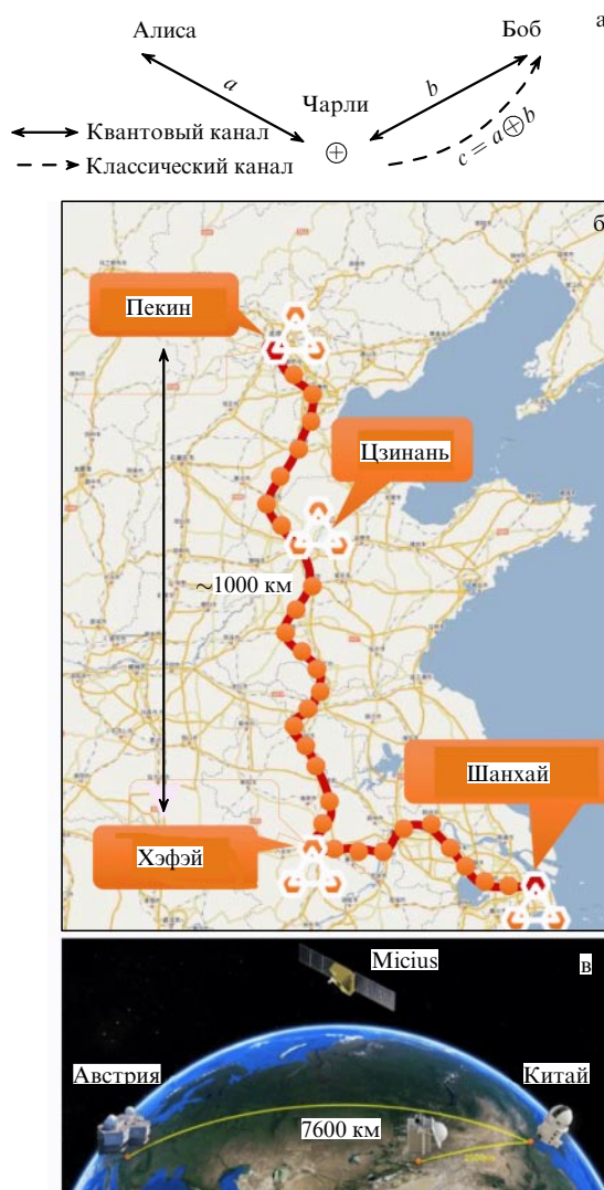
Рис. 14. КРК с доверенными узлами. (а) Принцип работы доверенного узла (см. текст). (б) Квантовая сеть на основе доверенных узлов в Китае между Пекином и Шанхаем [239]. (в) КРК между Китаем и Австрией, использующее спутник Micius в качестве доверенного узла [239]. (Рисунки б и в воспроизводятся из работы [239] с разрешения © 2018 Optical Society of America на условиях OSA Open Access Publishing Agreement.)
