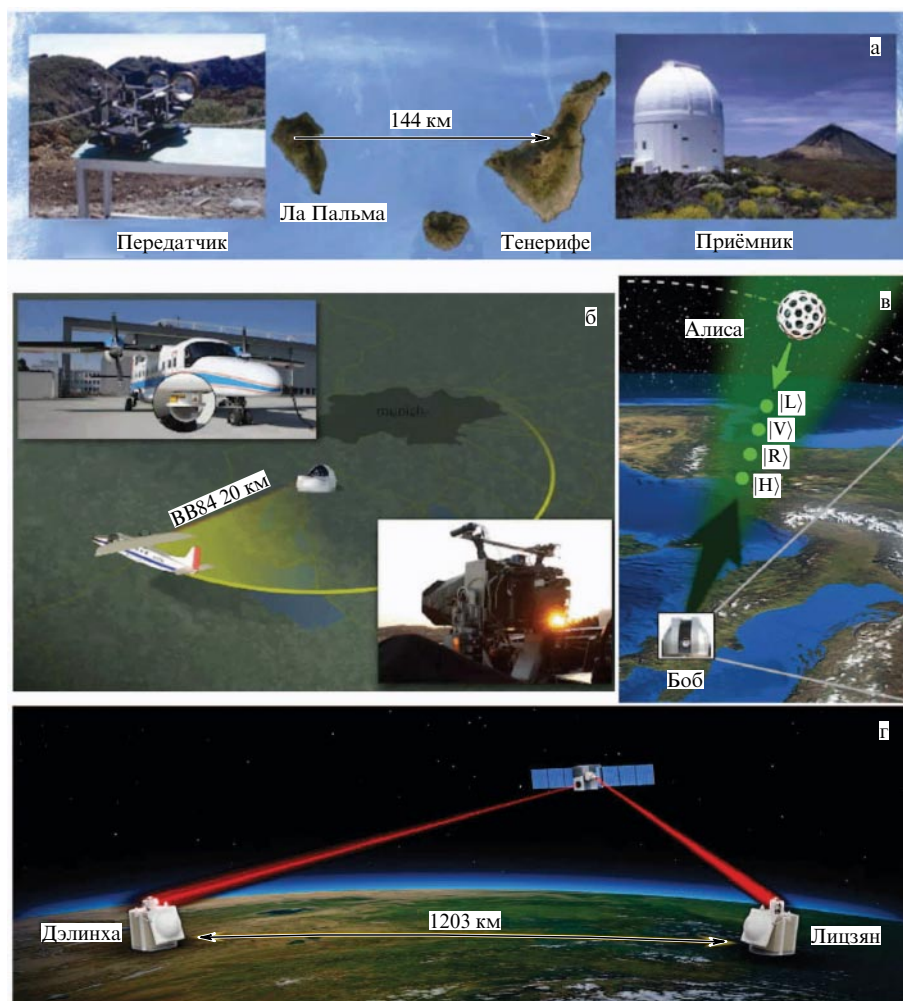
Рис. 13. (В цвете онлайн.) Атмосферная квантовая криптография. (а) КРК между двумя Канарскими островами. Слева изображено передающее устройство, справа — принимающий телескоп (рисунок воспроизводится из работы [223] с разрешения © 2007 Springer Nature). (б) КРК между наземной станцией и самолётом (рисунок воспроизводится из работы [224] с разрешения авторов (H. Weinfurter, F. Moll) и издательства © 2012 Society of Photo-optical Instrumentation Engineers (SPIE)). (в) КРК, использующее спутник в качестве ретрорефлектора (рисунок воспроизводится из работы [225] с разрешения © 2015 American Physical Society). (г) Схема распределения квантовой перепутанности с использованием источника перепутанных фотонов, расположенного на спутнике [226].
