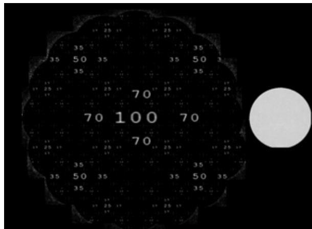
Рис. 6. Восстановленные изображения объекта (в левой части рисунка) и функции освещения (в правой части рисунка) после 47360-й итерации (370 циклов по 128 сканам). Диаметр объекта 50 мкм, диаметр функции освещения 13 мкм.
