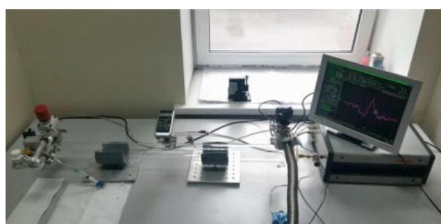
**Рис. 11.** Экспериментальный стенд на основе ТГц-нестационарного спектрометра, использованный для измерения концентрации ацетона в образцах выдыхаемого воздуха и мочи.
