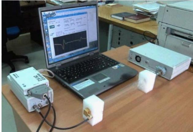
Рис. 4. Спектрометр ТГц-частотного диапазона на полупроводниковых элементах.
