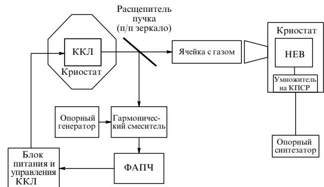
Рис. 7. Структурная схема спектрометра ТГц-частотного диапазона на основе ККЛ и НЕВ с системой ФАПЧ ККЛ.
