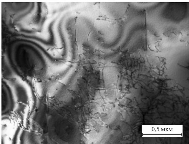
Рис. 15. Сплав  $\text{Ni}_{56}\text{Cr}_{44}$ . Закалка из жидкого раствора. Светлопольное изображение.
