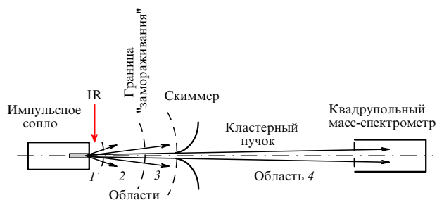
Рис. 1. Формирование кластерного пучка в условиях импульсной струи. Цифрами 1–4 показаны (схематически) зоны с разной степенью кластеризации пучка [37, 41].
