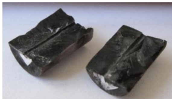
Рис. 15. Вид частей разрушенной толстостенной сапфировой капиллярной трубки после импульсного нагрева стержня изотропного графита MF-307 (начальная плотность 2,0 \text{ г см}^{-3} ). Исходный внешний диаметр трубки 10 мм, длина 18 мм. Диаметр внутреннего отверстия в сапфире 1 мм [4].
