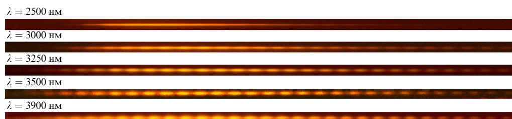
**Рис. 5.** Треки люминесценции ЦО, наведённых в LiF при одноимпульсной филаментации фемтосекундных импульсов на длине волны, варьируемой от 2500 до 3900 нм.
