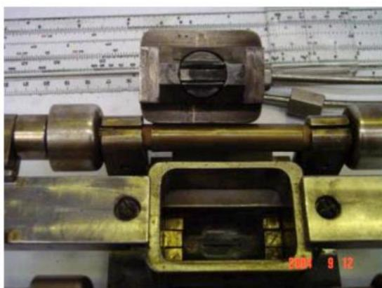
Рис. 25. Фотография ППИ с пенниговским разрядом. Видны катод и анодная вставка [13].
