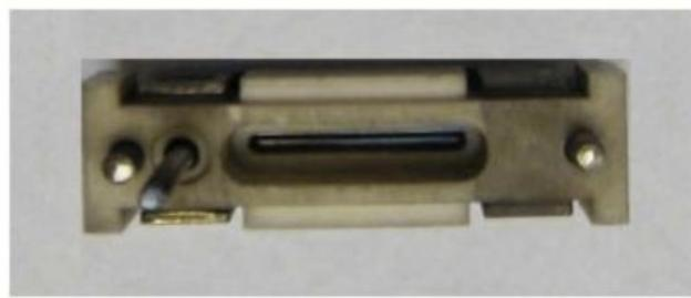
Рис. 30. Прототип ППИ планотронного типа, проданный БНЛ в Фермилаб.
