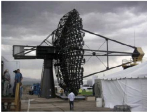
Рис. 3. Один рефлектор системы VERITAS — типичного черенковского телескопа третьего поколения.
