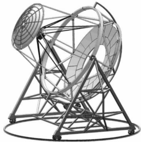
Рис. 5. Предполагаемый вид оптической системы с двумя зеркалами (телескоп Шварцшильда – Кудера) в проекте AGIS.
