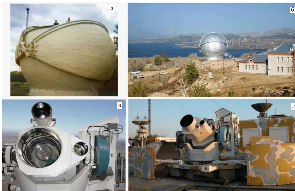
Рис. 1. Спутниковые лазерные дальномеры серии "Сажень-Т", предназначенные для второго поколения космических аппаратов ГЛОНАСС-М. (а) SLR-станция в Щёлково, введённая в строй в 2000 г. (б) Квантово-оптическая система Алтайского оптико-лазерного центра, введённая в строй в 2006 г. (в) Телескоп траекторных измерений Алтайского оптико-лазерного центра. (г) Передислоцируемая SLR-станция "Сажень-ТОС", введённая в строй в 2006 г., на космодроме Байконур.
