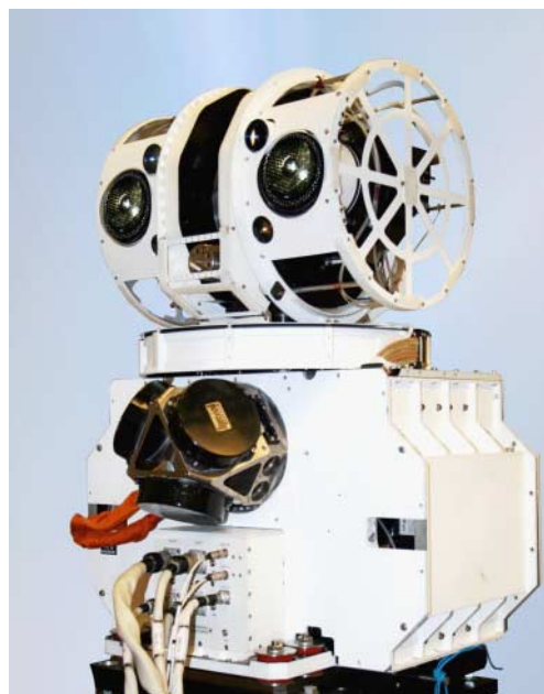
Рис. 8. Межспутниковая лазерная навигационно-связная система Терминал МЛНСС для ГЛОНАСС-М № 752, 753.
