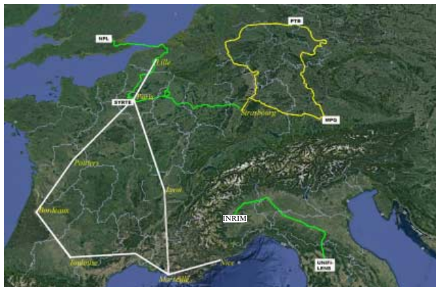
Рис. 1. (В цвете онлайн.) Оптоволоконные линии Европы для передачи высокоточных сигналов частоты с использованием фазы несущей. Жёлтым цветом отмечены выделенные линии, зелёным — общественные интернет-линии, белым — незадействованные линии, находящиеся на стадии обсуждения. INRIM — Istituto Nazionale di Ricerca Metrologica (Турин, Италия); SYRTE — SYstème de Références Temps Espace (Париж, Франция); MPQ — Max Planck Institute for Quantum Optics (Гархинг, Германия); NPL — National Physical Laboratory (Теддингтон, Великобритания); PTB — Physikalisch-Technische Bundesanstalt (Брауншвайг, Германия), UNIFI-LENS — Università di Firenze – Laboratorio Europeo di Spettroscopia non lineare (Флоренция, Италия).
