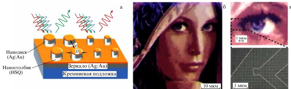
**Рис. 41.** (В цвете онлайн.) Цветная печать изображения с помощью плазмонных наночастиц, реализованная в работе [157]. (а) Каждый "пиксел" изображения состоит из составного нанодиска. Диаметр такого диска и расстояние между ближайшими соседними метаатомами определяют цвет рассеянного излучения. (б) Изображение в дальнем поле. (в) Часть изображения, увеличенная электронным микроскопом. Видно, что диаметр наночастиц определяет цвет изображения.
