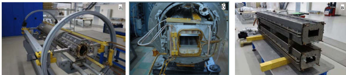
Рис. 23. Серийные магниты Бустера: дуплет квадрупольных линз (а), дипольный магнит (б) и предсерийный двухапертурный (одна апертура над другой) дипольный магнит Коллайдера (в).
