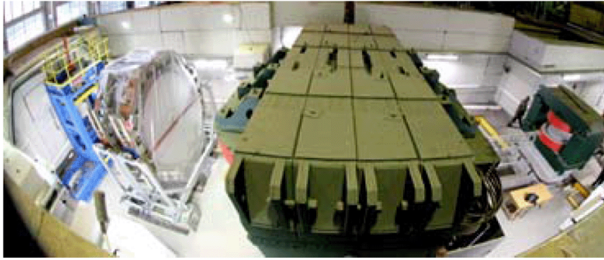
Рис. 19. Детектор BM@N в экспериментальной зоне на канале выведенных пучков из Нуклотрона (на переднем плане в центре — широкоапертурный анализирующий магнит, слева — гексагональные пропорциональные камеры, справа — корректирующий магнит на входной трассе пучка).
