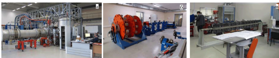
Рис. 24. Установка для испытаний СП-магнитов для проектов NICA и FAIR (а), участки производства СП-кабеля (б) и изготовления СП-обмоток (в).
