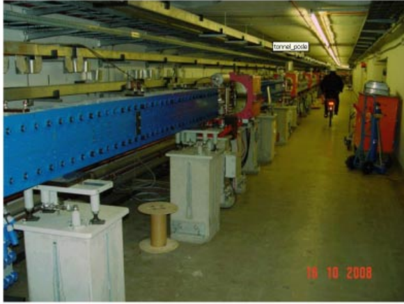
Рис. 20. Вигглеры-затухатели, установленные на источнике СИ PETRA III.
