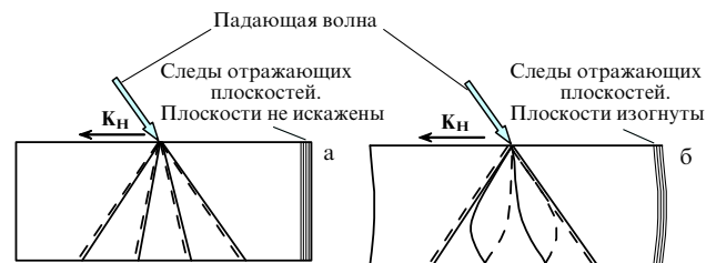
Рис. 2. Схема, иллюстрирующая поведение траекторий рентгеновских лучей нормальных и аномальных волн в идеальных (а) и деформированных (б) кристаллах. Сплошные линии — траектории лучей слабопоглощающейся волны, штриховые линии — траектории лучей сильнопоглощающейся волны.
