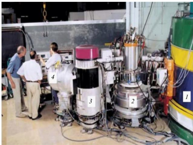
**Рис. 3.** Трёхосный спектрометр IN20 в Институте Лаэ–Ланжевена (Institut Laue–Langevin — ILL) (Гренобль) [26]: 1 — массивная защита монохроматора, 2 — стол образца (с гониометром и образцом в криостате), 3 — анализатор, 4 — детектор (каждый в своей защите).
