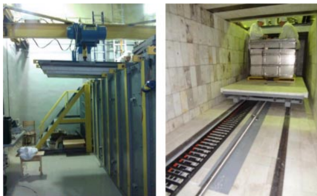
Рис. 24. (В цвете онлайн.) Общий вид пассивной защиты снаружи и изнутри. Диапазон перемещений детектора в нейтринном канале составляет 6–12 м от активной зоны реактора.
