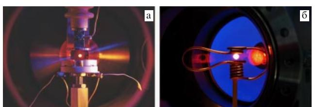
**Рис. 3.** Общий вид левитационных камер с образцами. (а) Левитация жидкого образца (капли) в электростатическом левитаторе в атмосфере сверхвысокого вакуума. (б) Левитация капли в электромагнитном левитаторе при наложении переменного электромагнитного поля.
