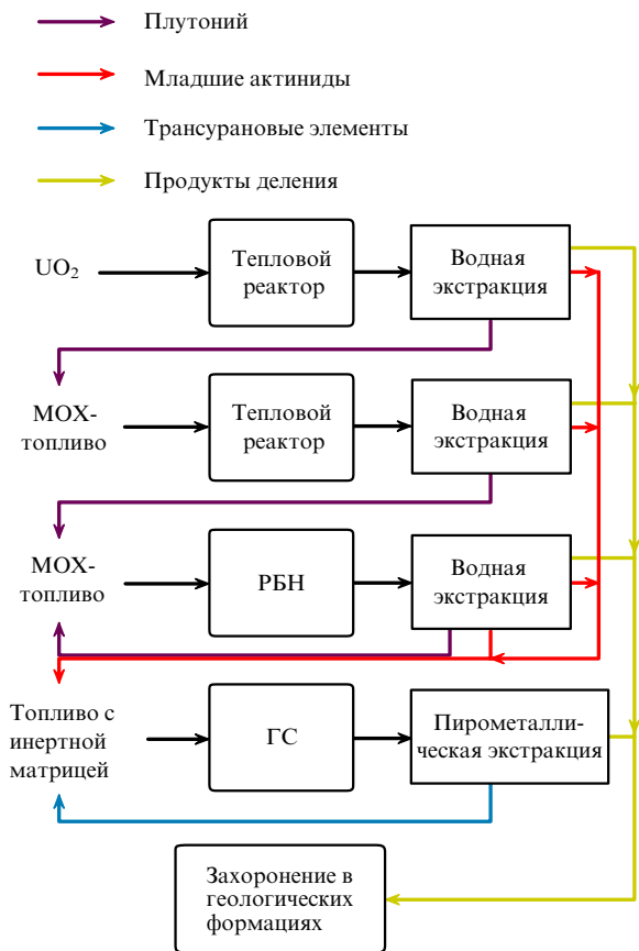
Рис. 3. Пример схемы замыкания ЯТЦ с дожиганием МА в гибридной системе.
