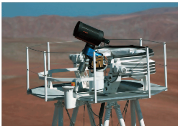
Рис. 5. Один из девяти каналов базового модуля телескопа SAINT.
