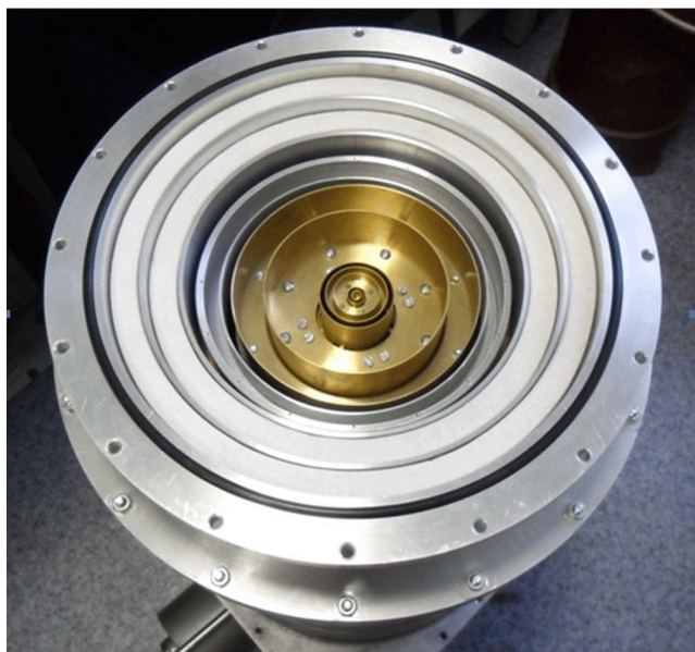
Рис. 2. Трёхдиапазонный облучатель в криостате (без радиопрозрачного окна).
