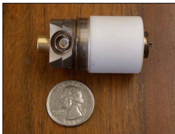
Рис. 6. Рентгеновская трубка с автоэмиссионным катодом компании Oxford Instruments.
