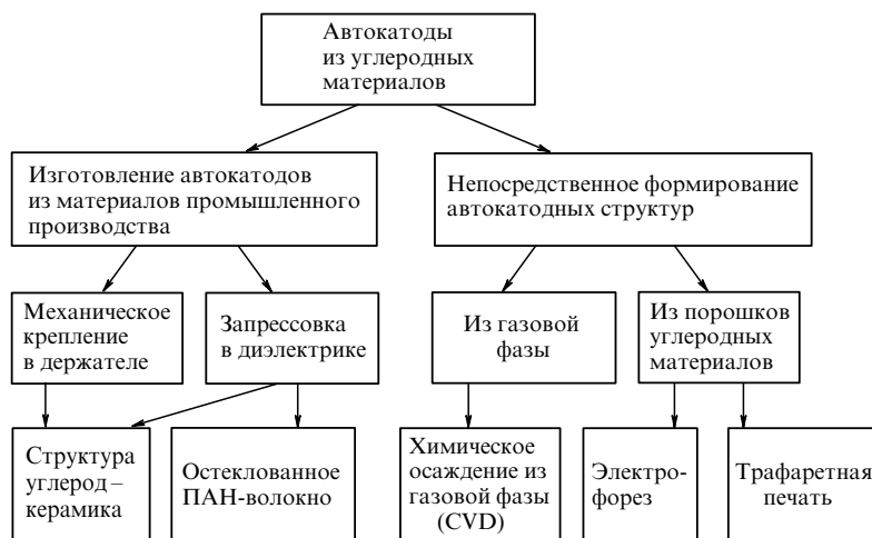
Рис. 12. Классификация основных методов изготовления автокатодов из углеродных материалов. ПАН — полиакрилонитрильное (волокно).
