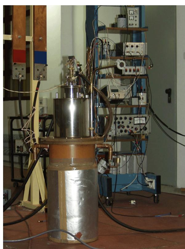
**Рис. 6.** Импульсный магнит (48 Тл) с гелиевым криостатом и измерительной вставкой в магнитном зале МЛ. Магнит помещён в пластиковый криостат с жидким азотом.
