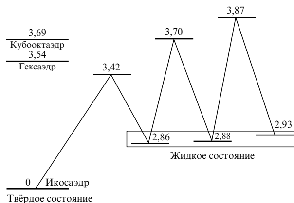
Рис. 8. Выраженные в единицах энергии разрыва одной связи D энергии возбуждения нижних конфигурационных состояний для кластера, содержащего 13 атомов, с леннард-джонсовским взаимодействием между ними, и энергии барьеров, разделяющих эти состояния [96].
