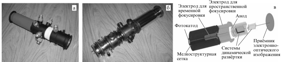
Рис. 3. Фемтосекундная фотоэлектронная пушка (а), многофункциональное устройство ЭОП–фотоэлектронная пушка (б) и его геометрическая конфигурация (в).
