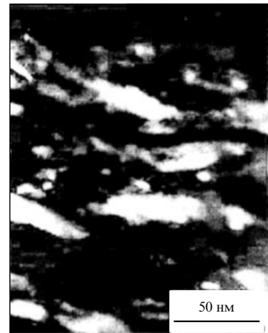
Рис. 5. Наноразмерные кристаллы \alpha -мартенсита, возникшие при криогенной ( T = 77 К) деформации в сплаве Fe–Ni–Cr–Al; темнопольное электронно-микроскопическое изображение в рефлексе \alpha -фазы.
