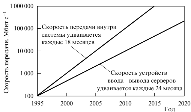
Рис. 1. "Дорожная карта" для роста скорости передачи на один канал в стандарте Ethernet (центры по обработке данных) и интегральной скорости передачи внутри системы. Число линий передачи на одну интегральную линию постоянно возрастает (с 2-х в 2000 году до 10 в 2010 году), а скорость устройства ввода–вывода выросла с 500 \text{ Мб с}^{-1} до 10 \text{ Гб с}^{-1} , соответственно.
