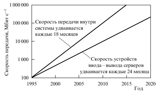
Рис. 1. "Дорожная карта" для роста скорости передачи на один канал в стандарте Ethernet (центры по обработке данных) и интегральной скорости передачи внутри системы. Число линий передачи на одну интегральную линию постоянно возрастает (с 2-х в 2000 году до 10 в 2010 году), а скорость устройства ввода–вывода выросла с  $500 \text{ Мбит с}^{-1}$  до  $10 \text{ Гбит с}^{-1}$ , соответственно.
