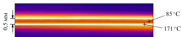
Рисунок. Изображение боковой грани нагретой пластины молибдена. По данным тепловизора температура центральной части грани равна 85 °C, а температура участков, прилегающих к рёбрам пластины, равна 171 °C.
