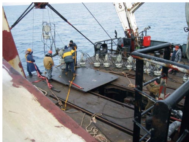
Рис. 2. Установка 16-элементного излучающего комплекса в подводное положение с борта научно-исследовательского судна.
