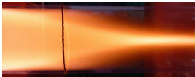
Рис. 2. Структура высокочастотного разряда в магнитоактивной плазме ( p = 10^{-2} торр): область фокуса резонансной поверхности полей ВЧ-источника с выходом в плазменно-волновой канал. Центральное возбуждающее кольцо находится слева, правое заземлённое кольцо видно на фотографии.
