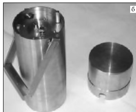
Рис. 3. Генератор стронция/рубидия-82 для позитрон-эмиссионной томографии: (а) принцип работы генератора, (б) внешний вид генератора.
