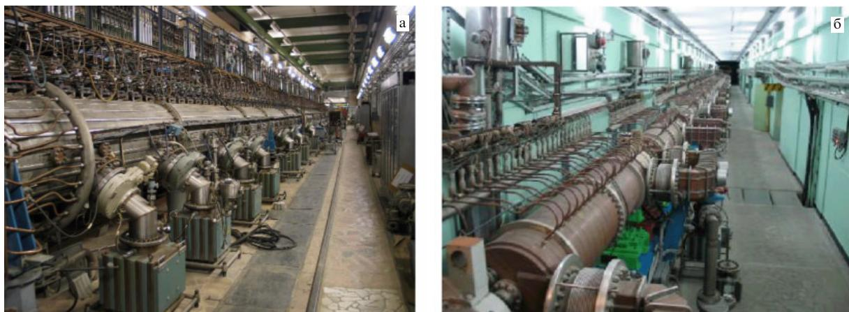
**Рис. 1.** Сильноточный линейный ускоритель протонов ИЯИ РАН: (а) начальная (до 100 МэВ) часть ускорителя, (б) основная (100–600 МэВ) часть ускорителя.
