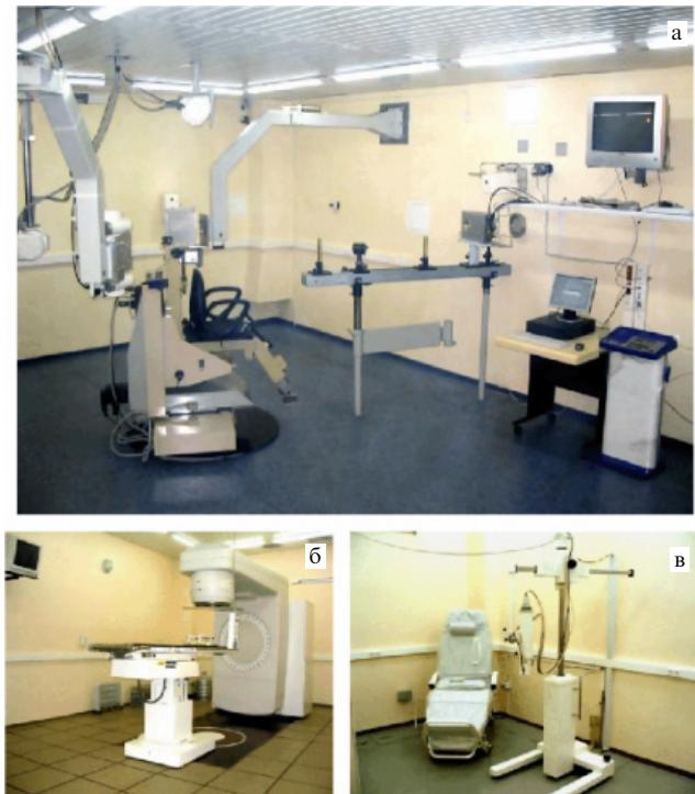
**Рис. 4.** Радиологические установки Комплекса лучевой терапии ИЯИ РАН: (а) камера протонной терапии, (б) ускоритель электронов СЛ-75-5 МТ, (в) рентгенотерапевтическая установка РТА-02.
