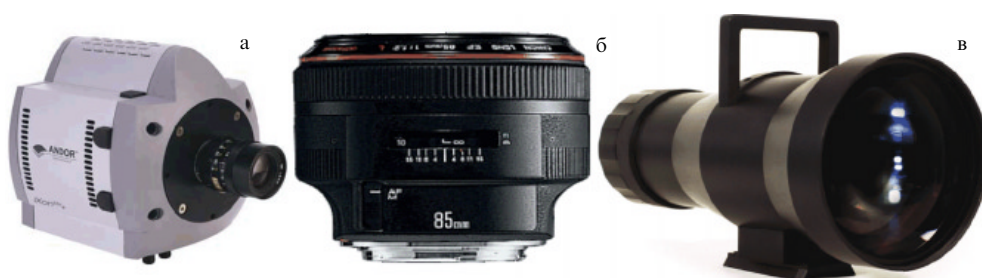
Рис. 10. Возможные массово производимые комплектующие для проектируемой системы: (а) ПЗС-матрица с внутренним усилением "Andor iXon EM +888" с форматом 1024 \times 1024 пикселя размером 13 мкм каждый; (б) объектив "Canon" EF 85 f/1,2 L USM II, способный проецировать поле размером 9 \times 9 градусов при масштабе 31"/пиксель на эту матрицу; (в) объектив "Marshall Electronics" 140 мм f/1,0, который даёт поле 5,4 \times 5,4 градусов при масштабе 19"/пиксель.
