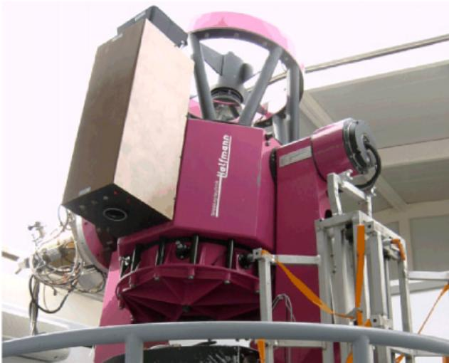
**Рис. 2.** Изображение камеры TORTORA, смонтированной на роботическом телескопе REM в обсерватории Ла Силла (ESO, Чили).
