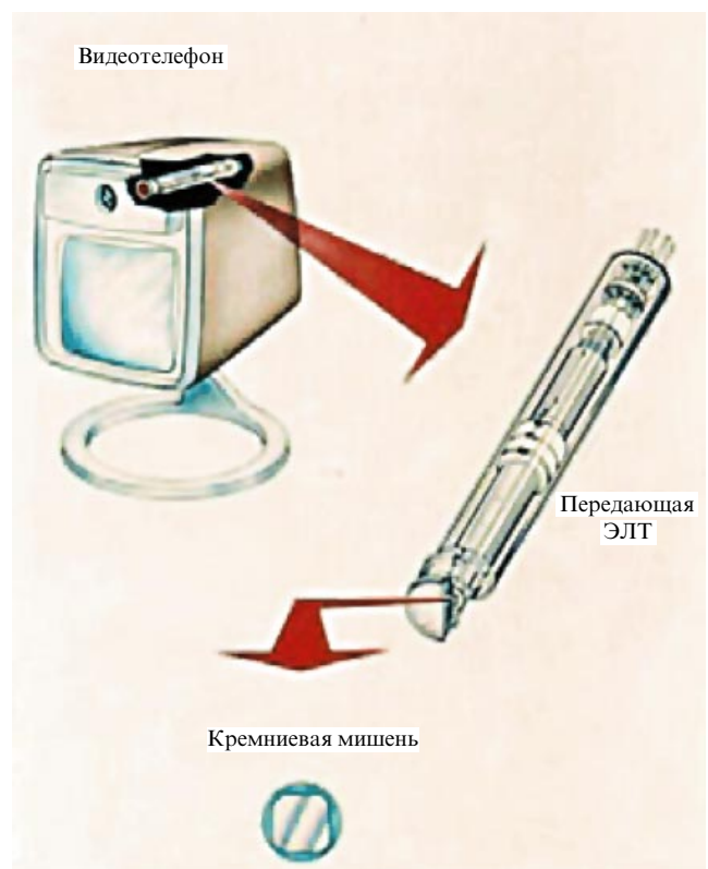
Рис. 2. Видеотелефон и передающая электронно-лучевая трубка на матрице кремниевых диодов.
