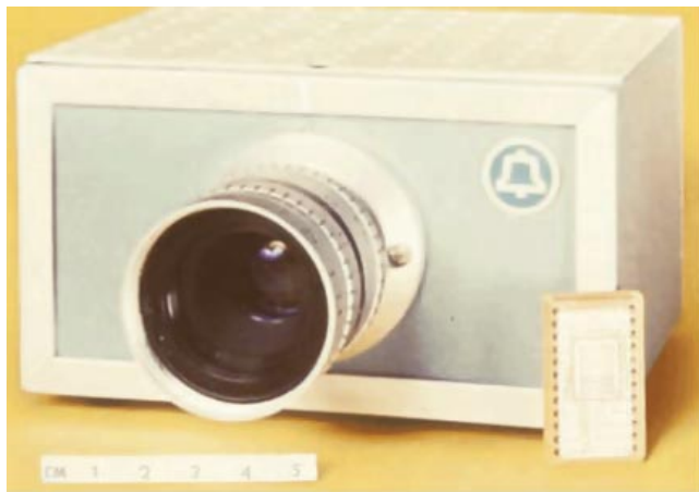
Рис. 13. Фоточувствительная ПЗС-микросхема, изготовленная для видеотелефона, и автономная телекамера.
