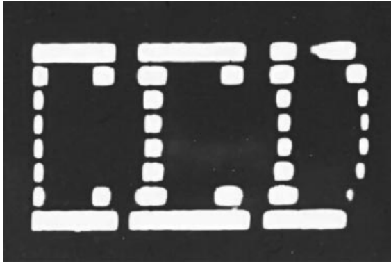
Рис. 9. Вывод на экран осциллографа выходного сигнала с восьми-пиксельного ПЗС, используемого в качестве детектора изображения.
