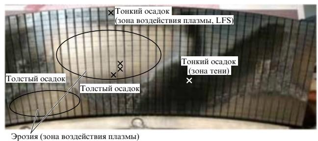
Рис. 3. Области эрозии и осаждённых плёнок в диверторе французского токамака Tore Supra (LFS — Low-Field Side).
