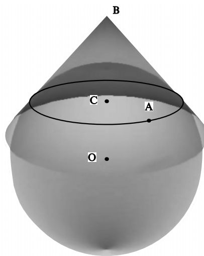
Рис. 2. Земля представлена как идеальная сфера с центром в точке О и радиусом |\mathbf{OA}| . Маятник Фуко помещён в точку А на окружности полярного угла \vartheta = \angle BOA . За один сидерический день маятник совершает оборот вокруг Земли. Параллельный перенос плоскости качания маятника проще представить как параллельный перенос нормального к ней вектора. Этот вектор принадлежит касательному пространству сферы, а также конуса с вершиной В (похожего на вьетнамскую шляпу), который касается поверхности Земли на широте маятника. С — центр окружности, вдоль которой движется маятник. Точки В, С, О расположены на оси вращения Земли.
