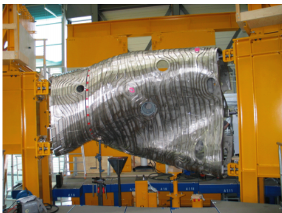
Рис. 9. Фрагмент вакуумной камеры W-7X (половина модуля).
