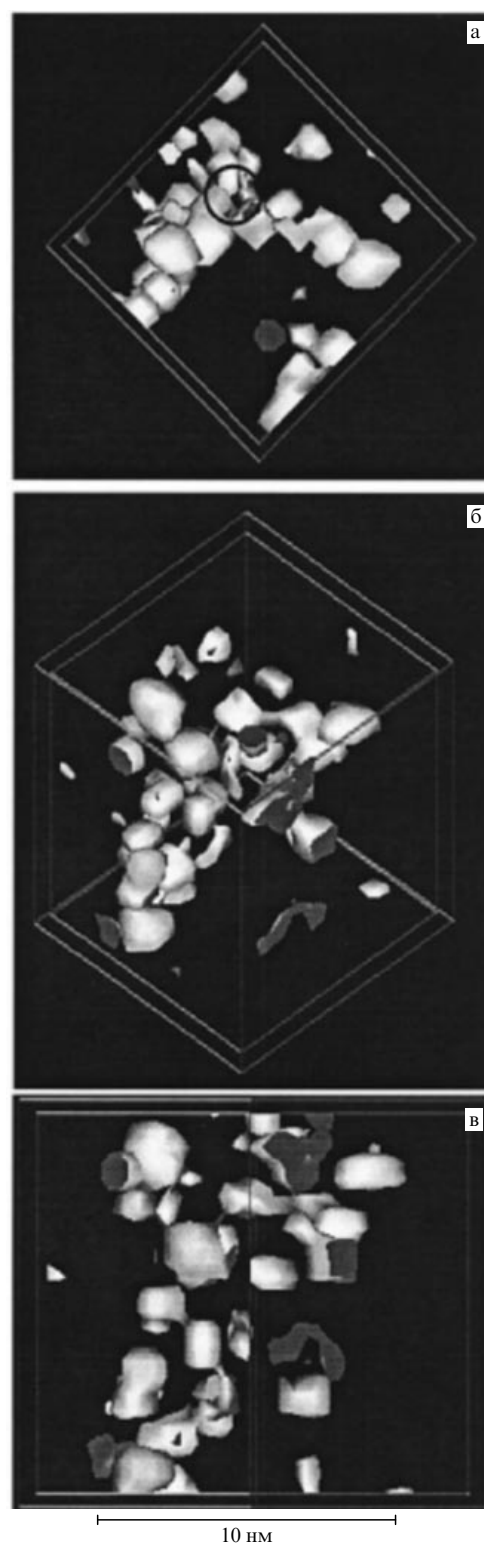
Рис. 19. Результаты [89] ECOPoSAP анализа областей материала непосредственно над дислокацией. Показаны изоконцентрационные (4 ат.% С) поверхности в сегрегационной атмосфере при трех различных позициях (углах) наблюдения. Ширина анализируемой области составляет 10 \pm 1,5 нм, глубина анализа \sim 4 нм. Локализация дислокации показана темным кружком в (а).
