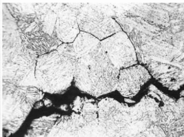
Рис. 2. Аварийное разрушение взрывного типа стального водородного цилиндрического баллона. Показано, в частности, межзеренное (водородное) растрескивание материала [2].
