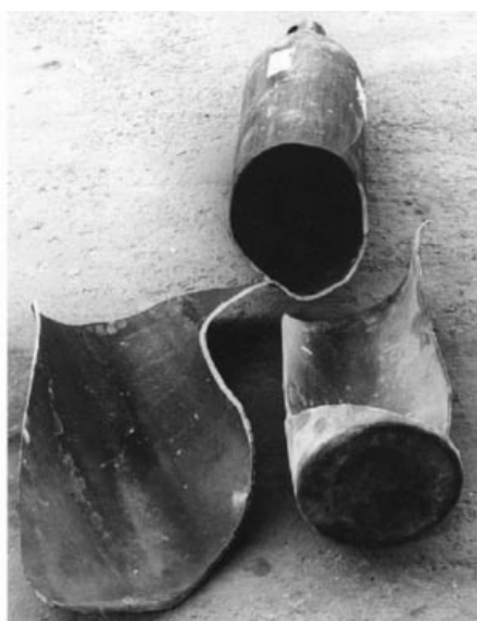
Рис. 2. Аварийное разрушение взрывного типа стального водородного цилиндрического баллона. Показано, в частности, межзеренное (водородное) растрескивание материала [2].
