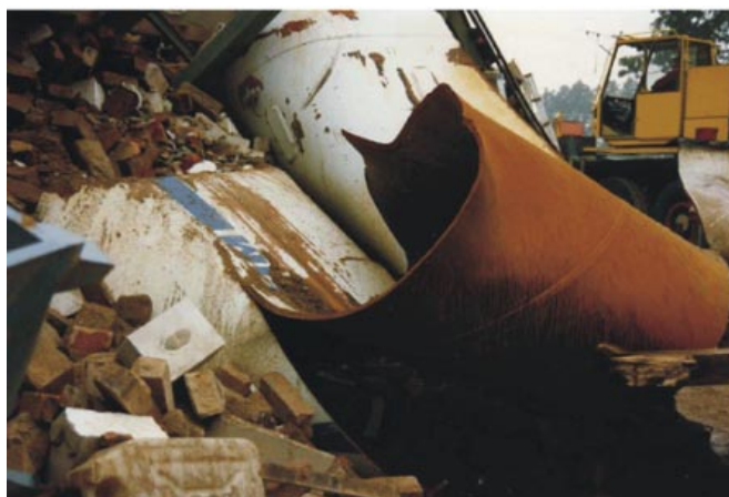
Рис. 3. Аварийное разрушение взрывного типа стального резервуара для хранения газообразного водорода при высоком давлении [2].
