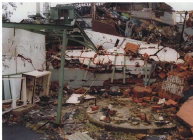
Рис. 3. Аварийное разрушение взрывного типа стального резервуара для хранения газообразного водорода при высоком давлении [2].
