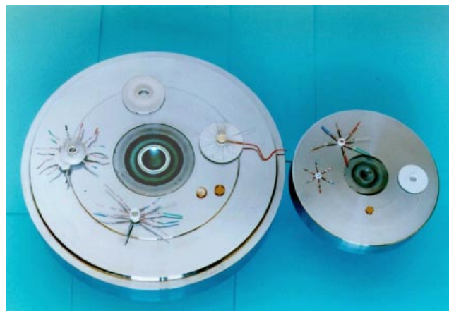
Рис. 8. Камеры высокого давления типа "тороид".
