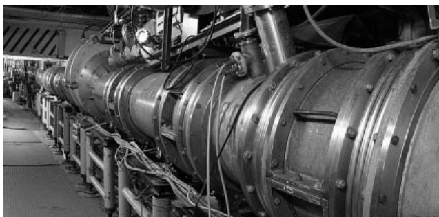
Нуклотрон: фрагмент кольца ускорителя в районе инжекции пучка.
