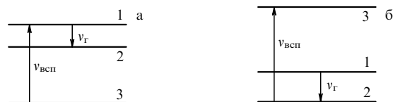
Рис. 1. Иллюстрация метода инверсии населенностей уровней с помощью вспомогательного излучения (накачки). \nu_{\text{всп}} — частота вспомогательного излучения, \nu_r — частота сигнала, на которой может быть получена генерация.
