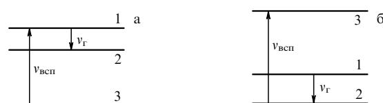
Рис. 1. Иллюстрация метода инверсии населенностей уровней с помощью вспомогательного излучения (накачки).  $v_{\text{всп}}$  — частота вспомогательного излучения,  $v_r$  — частота сигнала, на которой может быть получена генерация.
