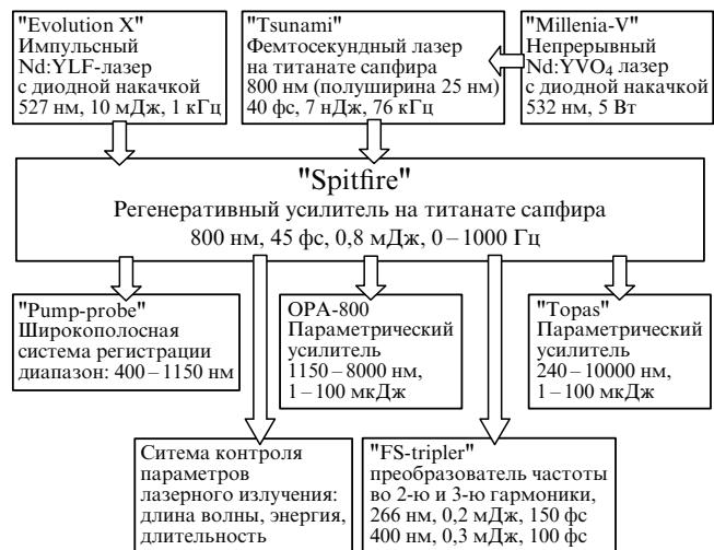
Рис. 3. Блок-схема основных лазерных компонентов комплекса ЦКП "Оптико-спектральные исследования" ИСАНа.
